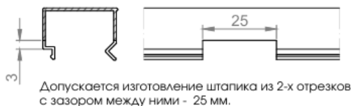
Обработка штапика в зоне заглушки РПИ-640.06
